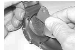
Abb. 103 - AUSBAU DES BATTERIEDECKELS (Werkzeug)
