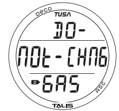
Fig. 75 - DONT SWITCH GAS ALARM
