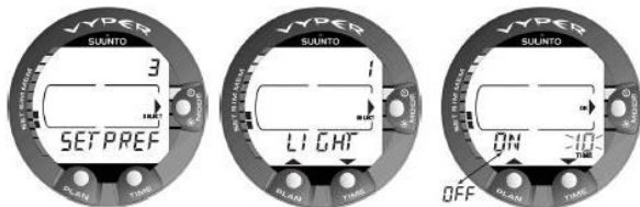
Figure 3.8. Réglage de la durée du rétroéclairage. Appuyez sur les boutons de défilement pour activer ou désactiver le rétroéclairage et pour définir sa durée.
