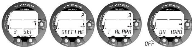
Figure 3.7. Réglage de l'alarme quotidienne [3 T ALARM]
