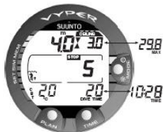
Figure 4.9. Un palier de décompression obligatoire. Vous devez effectuer un palier de décompression obligatoire à une profondeur comprise entre 6 m et m (20 ft et ft). Appuyez sur le bouton TIME pour voir l'affichage des raccourcis.
