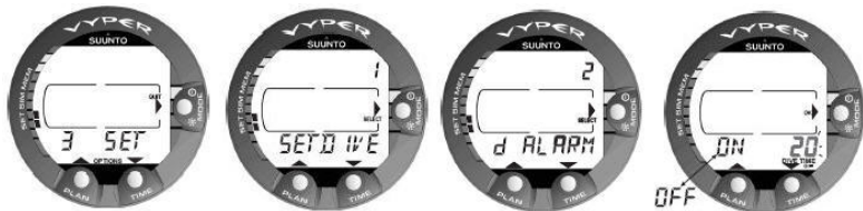
Figure 4.2. Alerte durée d'immersion Appuyez sur les boutons de défilement pour activer ou désactiver l'alerte et pour définir la valeur de la durée d'immersion.
