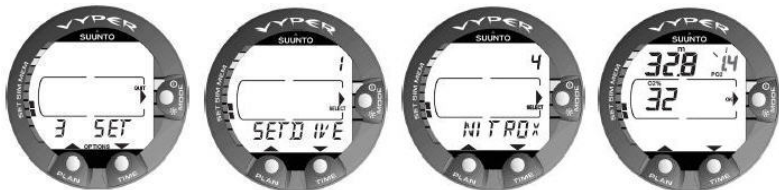
Figure 4.4. Réglage du pourcentage d'oxygène et de la pression partielle. La profondeur maximale équivalente est affichée sur 32,8 m (107 ft). Appuyez sur les boutons de défilement pour changer le pourcentage d'oxygène et définir la valeur du paramètre de pression partielle d'oxygène.
