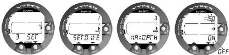
Figure 4.3. Réglage de l'alerte profondeur maximale. Appuyez sur les boutons de défilement pour activer ou désactiver l'alerte et pour définir la valeur de profondeur maximale.
