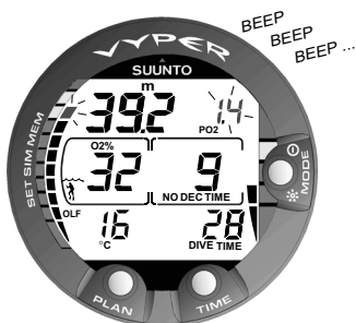
Fig. 3.23. Affichage de la pression partielle d'oxygène et de l'indicateur OLF. Une alarme sonore retentit quand la pression partielle est supérieure à 1,4 bar ou à la valeur choisie et l'indicateur OLF a atteint 80%.
