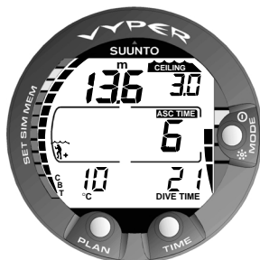
Fig. 3.17. Plongée avec décompression, au-dessus de la profondeur plancher. La flèche a disparu et la mention ASC TIME ne clignote plus. Le plongeur est dans la zone de décompression.
