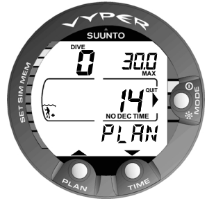
Fig. 3.6. Planning de plongée. Le planning est signalé par l'abréviation PLAN. Le temps disponible sans décompression à 30.0 m est de 14 minutes en mode A0/P1.
