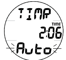
Fig. 55B - DIVE ALT 1 (CDT set for Auto)
