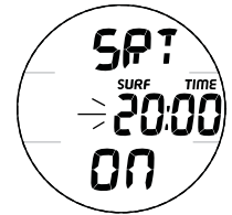
Fig. 29 - SET SRT ALARM
