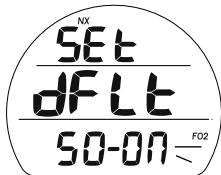
Fig. 26 - RÉGLAGE DU FO2 PAR DÉFAUT
