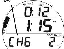
Fig. 8 - PILE FAIBLE (la situation s'est présentée au cours de la plongée)
