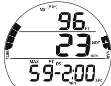
Fig. 42 - PRÉVISUALISATION D'UN PALIER PROFOND
