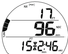
Fig. 44 - ÉCRAN PRINCIPAL DE PALIER DE SÉCURITÉ
