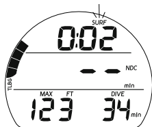
Fig. 39 - ÉCRAN PRINCIPAL DE PLONGÉE SANS DÉCOMPRESSION
