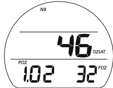
Fig. 41 - ÉCRAN COMPLÉMENTAIRE ALT 2 DE PLONGÉE SANS DÉCOMPRESSION
