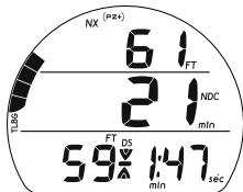
Fig. 43 - ÉCRAN PRINCIPAL DE PALIER PROFOND
