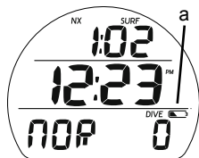
Fig. 7 - MISE EN GARDE DE PILE FAIBLE
