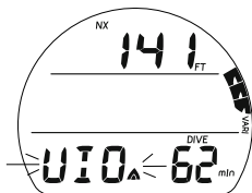
Fig. 54 - INFRACTION AVEC LIMITATION AU MODE PROFONDIMÈTRE ACTIVÉE (pendant les dix premières secondes)
