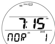
Fig. 18 - PRÉVISUALISATION DU MODE LOG
