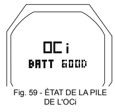
Fig. 59 - ÉTAT DE LA PILE DE L'OCI
