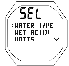
Fig. 141 - MENU DE RÉGLAGE DES UTILITAIRES (pour accéder au réglage du type d'eau)
