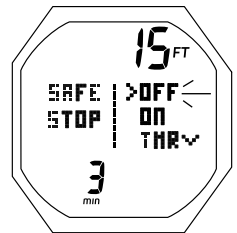
Fig. 46A - RÉGLAGE D'UN PALIER DE SÉCURITÉ
