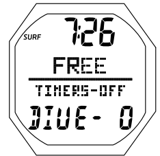
Fig. 114A - ÉCRAN PRINCIPAL SURFACE FREE (pas encore de plongée, minuteurs réglés sur OFF)
