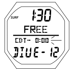
Fig. 149 - ALARME DU MINUTEUR DE COMPTE À REBOURS EN SURFACE
