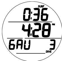
Fig. 100 - ÉCRAN PRINCIPAL DU MODE SURFACE GAUG (pas encore de plongée effectuée)
