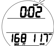
Fig. 104 - ÉCRAN PRINCIPAL DU MODE PLONGÉE GAUG (après moins de 10 min en surface)
