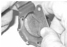
Fig. 136A - INSTALLATION DU COUVERCLE (avec outil)
