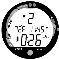
Fig. 67 - Surface Mode (>10 min)
