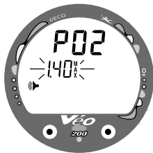
Fig. 34 - Set PO2 Alarm
