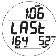
Fig. 101 - GAUG SURF ALT 1 (Last Dive's Data)
