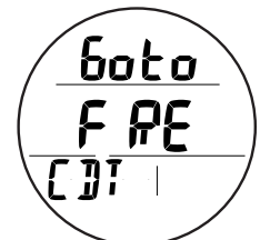
Fig. 136 - ÉCRAN D'ACCÈS AU MINUTEUR DE COMPTE À REBOURS
