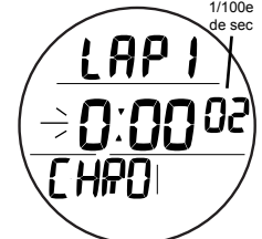
Fig. 17 - ÉTAT DU CHRONO (temps intermédiaire 1 démarré, en cours)
