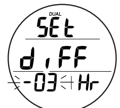
Fig. 27 - RÉGLAGE D'UN DOUBLE FUSEAU HORAIRE (si heure du lieu de résidence = heure par défaut)
