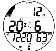
Fig. 105 - ÉCRAN PRINCIPAL D'INFRACTION PROVISOIRE (après signal sonore)
