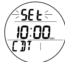
Fig. 15 - ÉTAT DU MINUTEUR DE COMPTE À REBOURS (après réglage)
