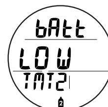
Fig. 5 - ÉTAT DE LA PILE DE L'ÉMETTEUR (mise en garde de pile faible)
