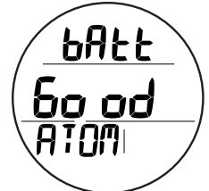
Fig. 79 - ÉTAT DE LA PILE DE L'ATOM
