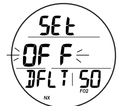
Fig. 48 - RÉGLAGE DU FO 2 PAR DÉFAUT
