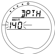
Fig. 53 - Set Depth Alarm
