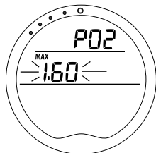
Fig. 59 - Set PO2 Alarm
